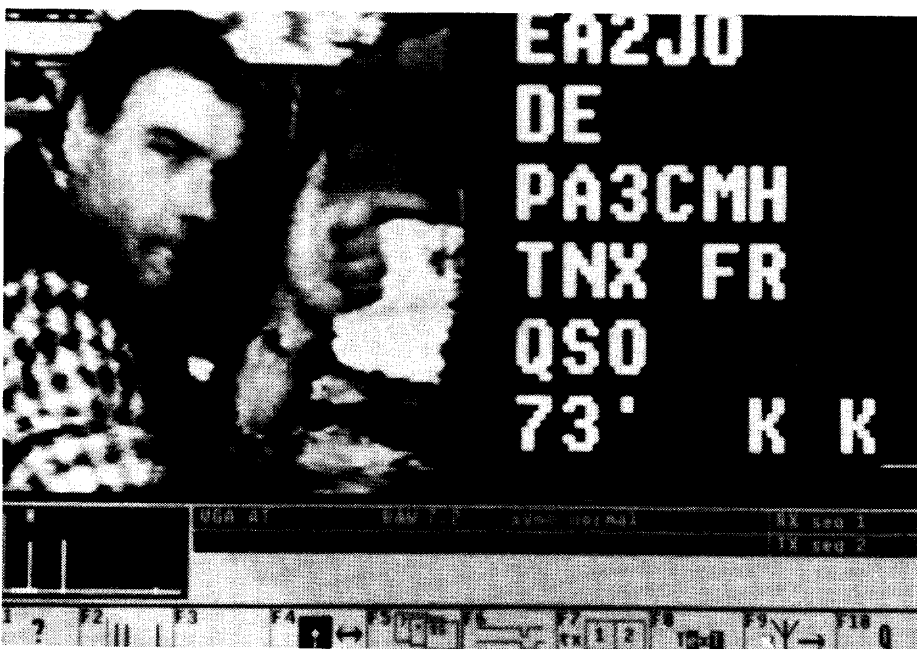
Foto 2 Het beeldscherm tijdens een QSO op 14 MHz. Het linker gedeelte is het ontvangtscherm en het rechter deel kan worden uitgezonden. Onderaan het beeldscherm is een deel waarin het frequentiespectrum van het ontvangen signaal wordt afgebeeld en een balk met de betekenis van de functietoetsen.
