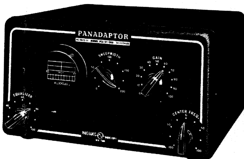
Fig. 3 - De 'Panadapter' (1946) en een 'typical display' van een 200 kHz spectrum op het 4,5 cm-schermpje van de eerste commerciële panorama-ontvanger voor radio-amateurs (volgens: Panaramic Handbook for Panadapter, Model PCA-2)
